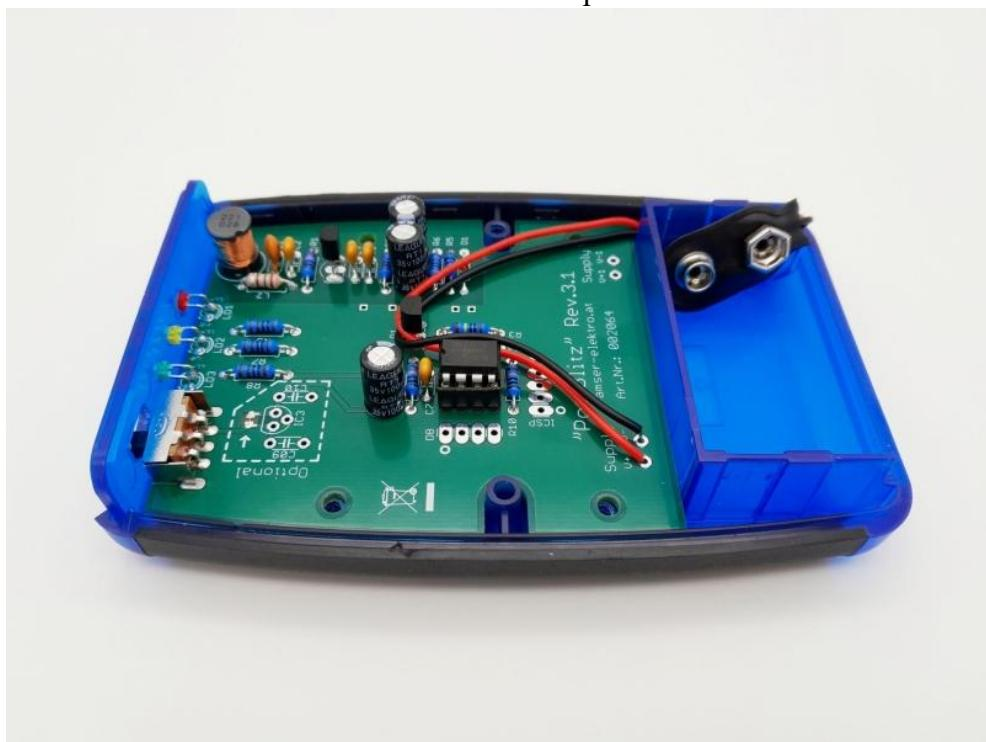
**• Schritt 9****Optional: Einbau in das Gehäuse**
