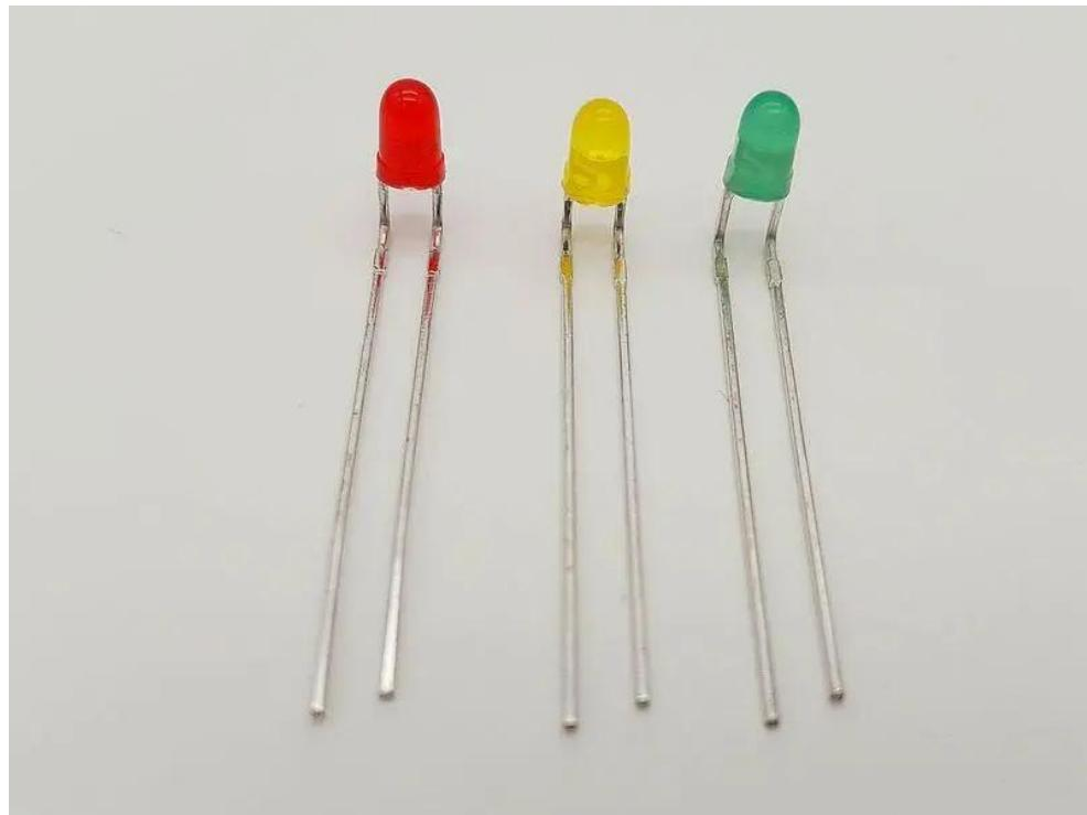
Der Pluspol der LEDs (Langer Draht) ist auf der Platine mit der Bezeichnung LL gekennzeichnet.
