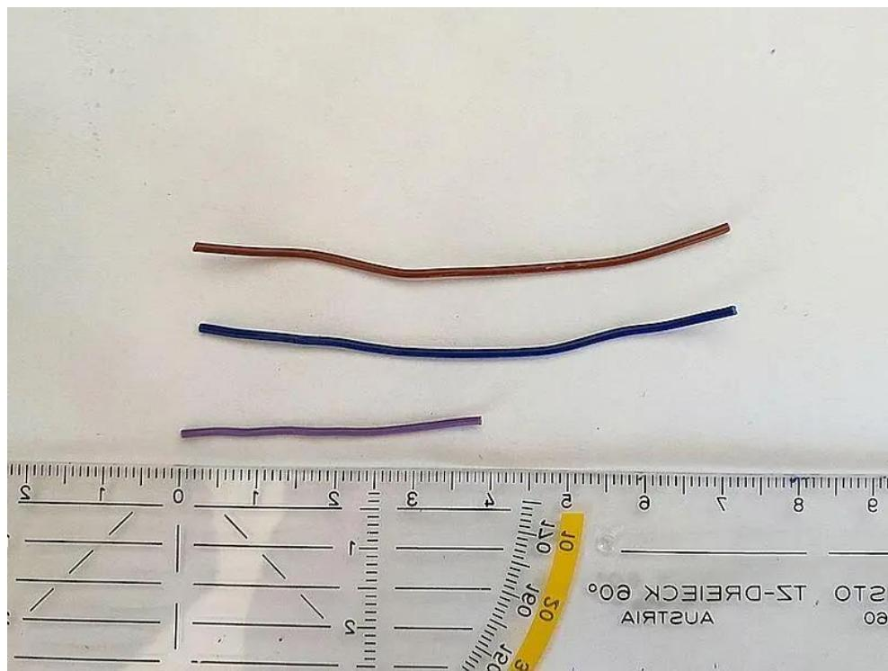
Nach dem Ablängen der Drähte werden Diese an die Batterieclips gelötet
